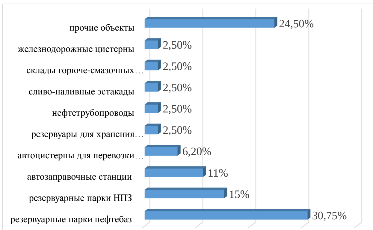
Рисунок 1 – Пожары, произошедшие на «объектах, связанных с хранением, транспортировкой и переработкой нефти и нефтепродуктов» [10]
