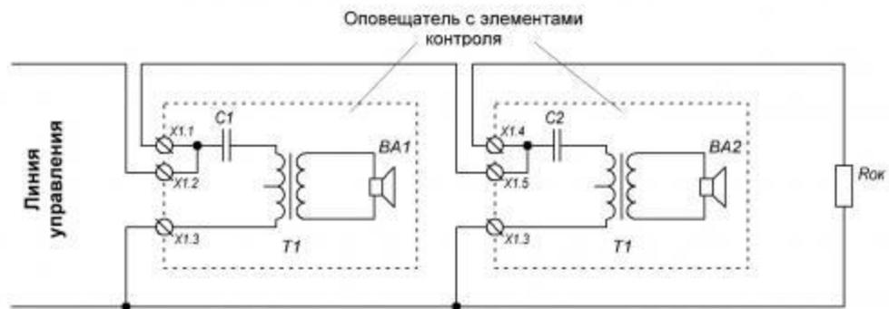
Рисунок 3- Способ контроля по постоянному току с блокирующими элементами
