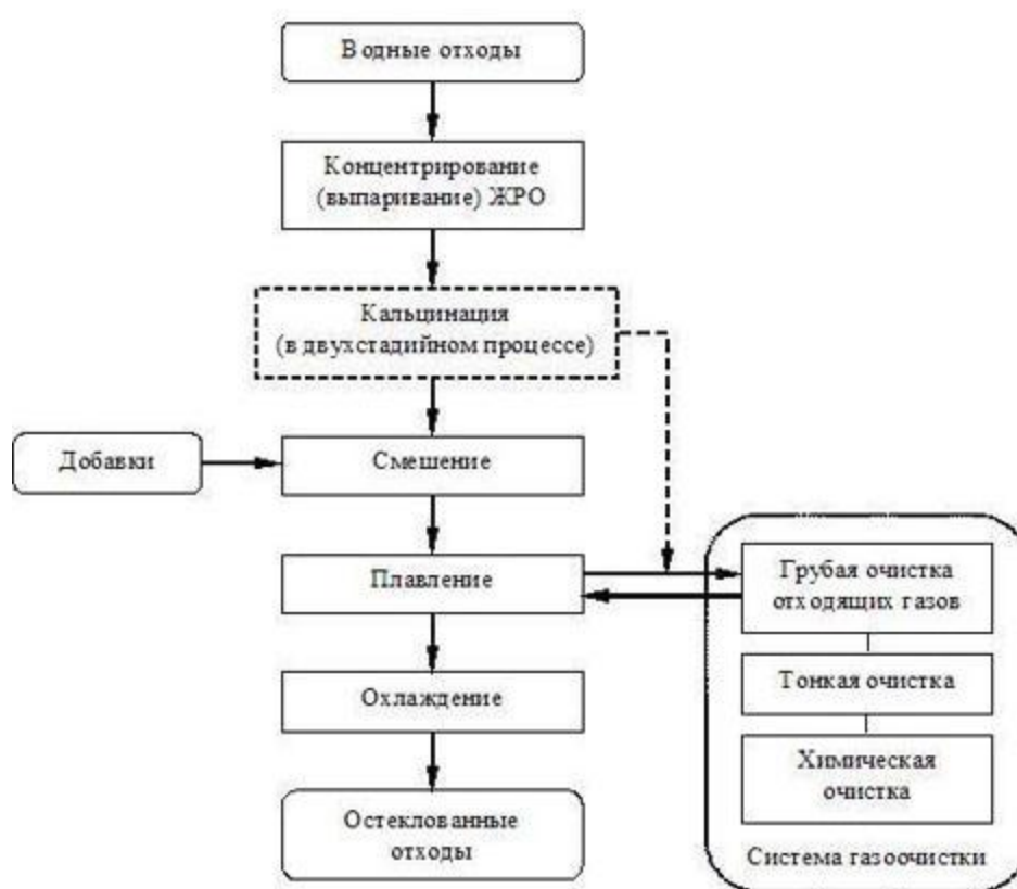
Рисунок 4 - Схема остекловывания радиоактивных отходов
