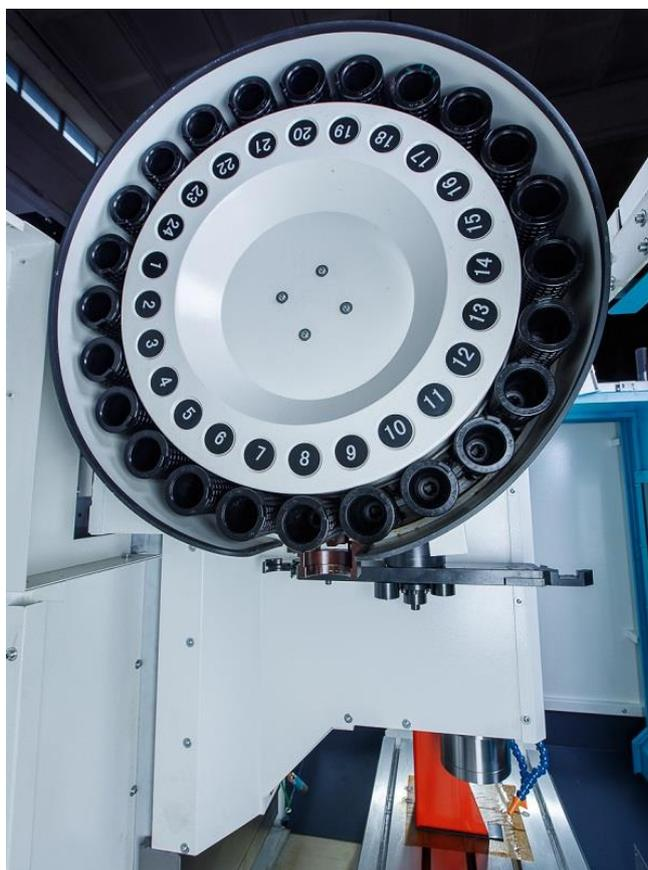
Рисунок 8 – 24-х позиционная система смены инструмента
