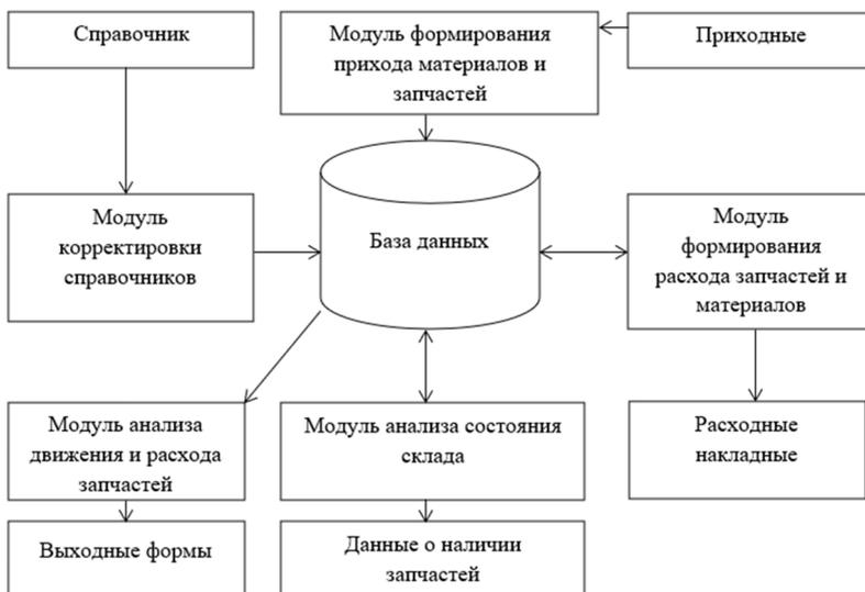
Рис. 16. Функциональная схема АРМ склада
