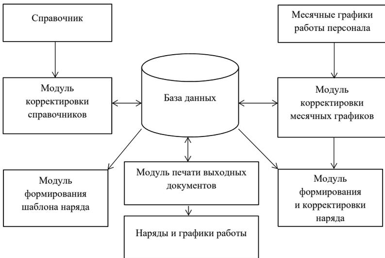
Рис. 12. Функциональная схема рабочего места диспетчера
