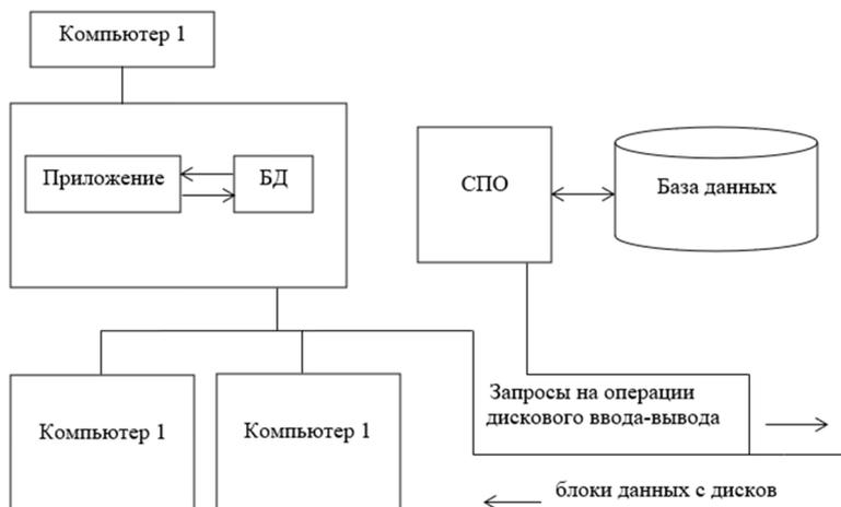
Рис. 6. Принципиальная схема работы технологии «файл-сервер»
