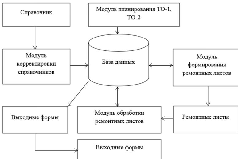
Рис. 15. Функциональная схема рабочего места ремонтной службы
