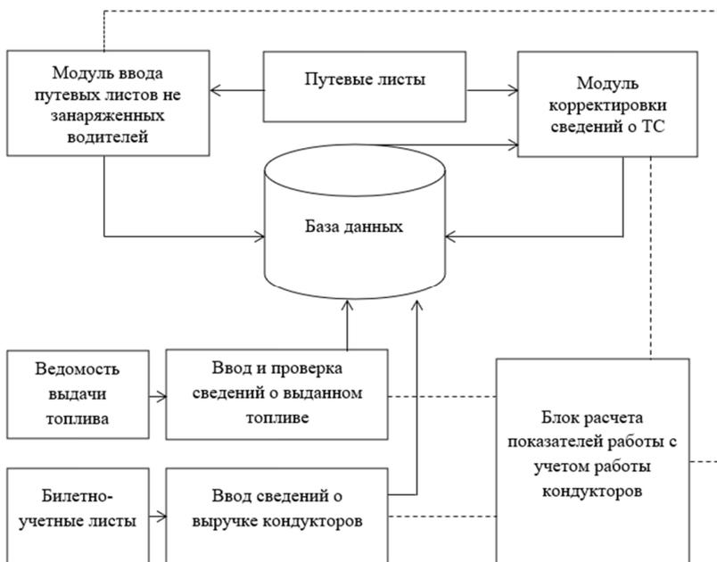
Рис. 13. Функциональная схема АРМ таксировщика
