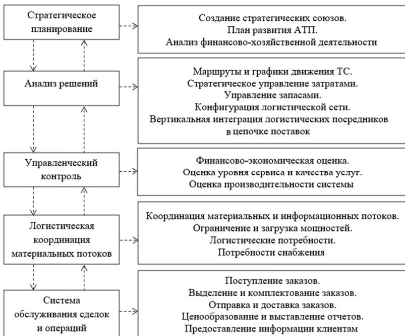
Рис. 23. Иерархическая структура системы информационного обеспечения перевозок
