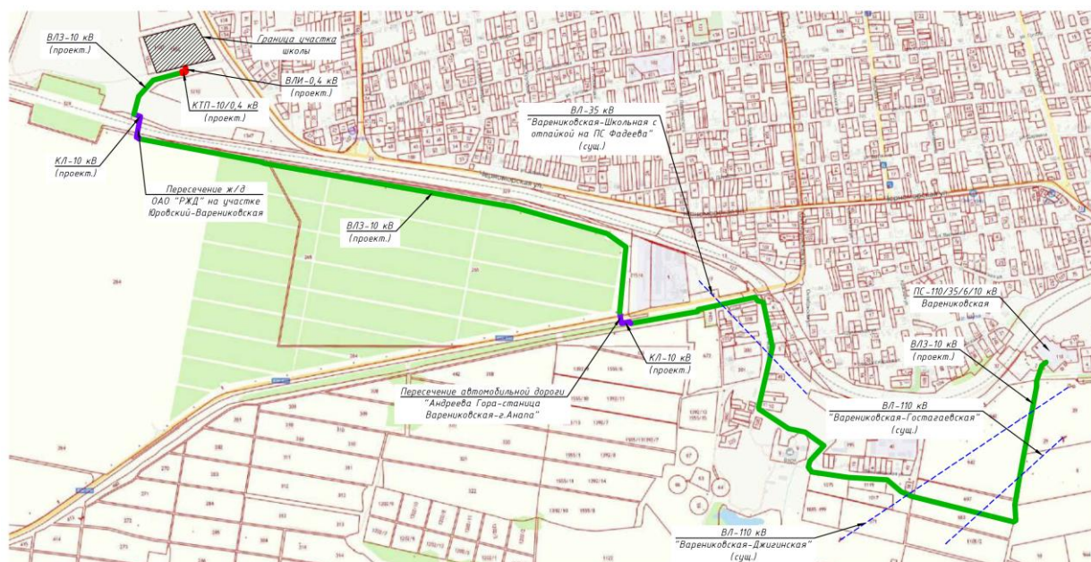
Рисунок 3 – Ситуационный план трассы ЛЭП 10 кВ и 0,4 кВ
