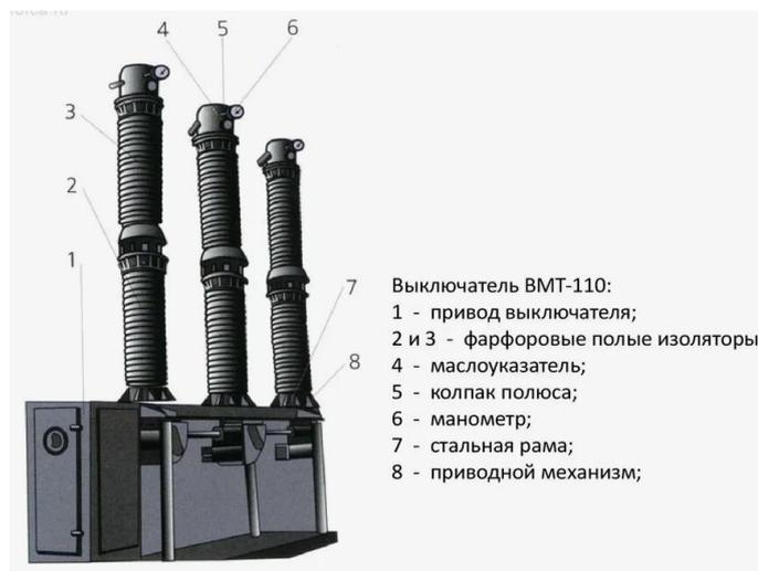
Рисунок 2 – Внешний вид масляных выключателей ВМТ-110Б-25/1250 ХЛ1
