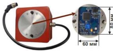
Рисунок 19 – Датчик ТЕСV.Р1-10
