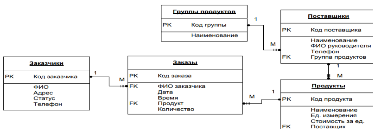
Рисунок 17 – Логическая модель базы данных АИС [18]
