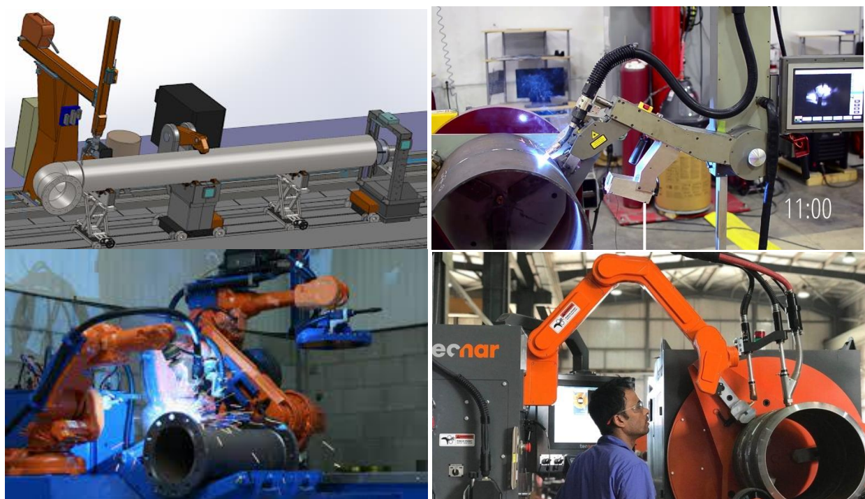
Рисунок 9 – Примеры промышленного внедрения роботизированной сварки при изготовлении элементов трубопровода
