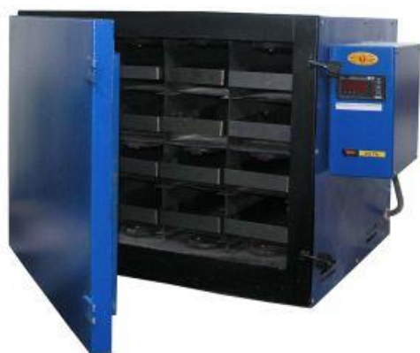
Рисунок 4 – Печи для прокалки и хранения электродов ПСПЭ 90-400 (а) и ПСПЭ 10-400 (б)
