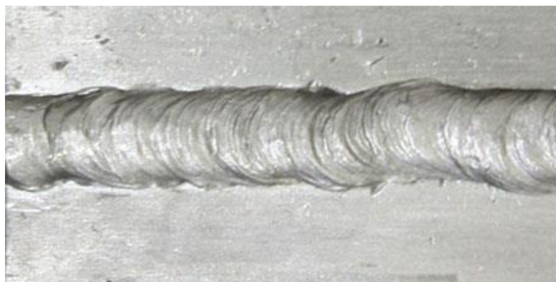
Рисунок 3 – Сварочный шов, выполненный электродами ОЗАНА-1
