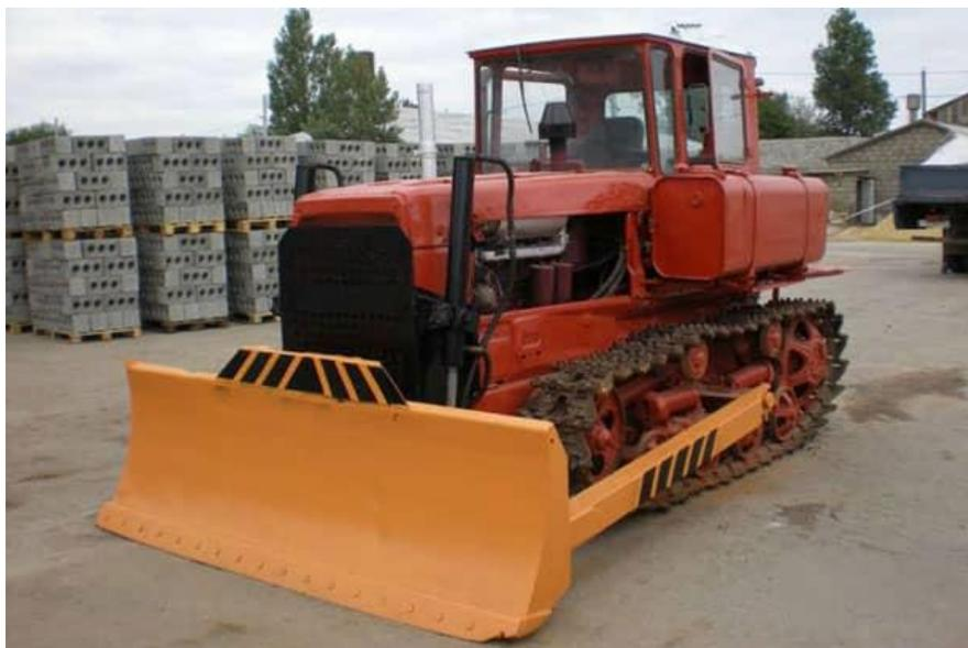
Рисунок 1 – Установленный на бульдозере ДТ-75 ковш ДЗ-42
