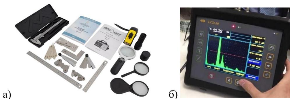
Рисунок 8 – Набор для проведения визуально-измерительного контроля (а) и ультразвуковой дефектоскоп UCD-50 (б)
