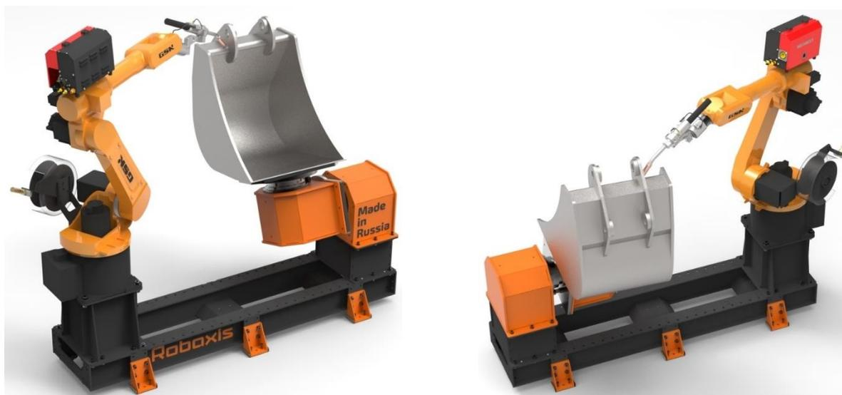
Рисунок 15 – Стенд для роботизированной сварки ковшей
