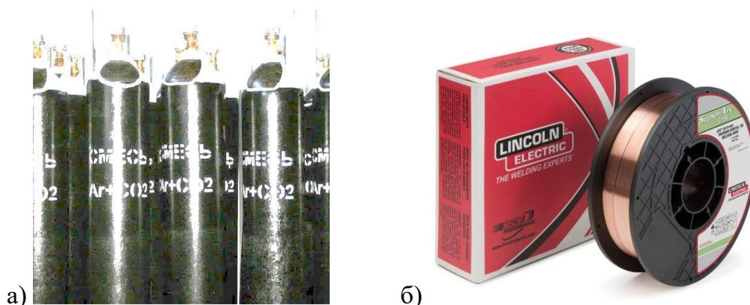
Рисунок 23 – Защитная газовая смесь (а) и сварочная проволока (б)
