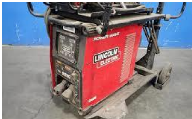
Рисунок 16 – Сварочный источник питания Power Wave S500 производства Lincoln Electric
