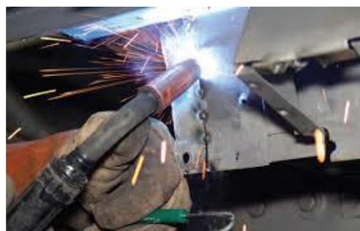
Рисунок 4 – Пример механизированной сварки в защитных газах при ремонте кузовов автомобилей
