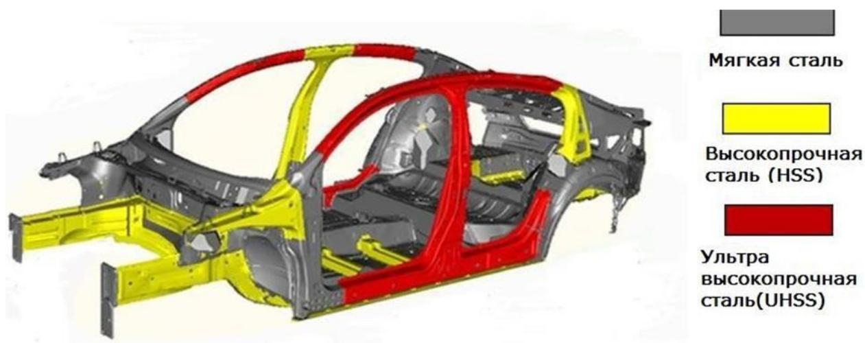
Рисунок 6 – Применение различных сталей при изготовлении автомобиля
