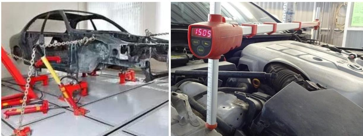
Рисунок 1 – Замер положений контрольных точек кузова
