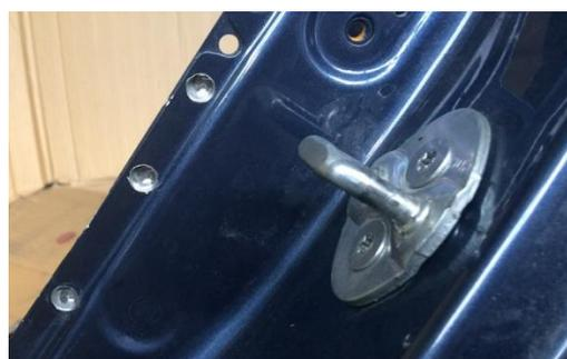
Рисунок 5 – Применение дуговой сварки для выполнения точек
