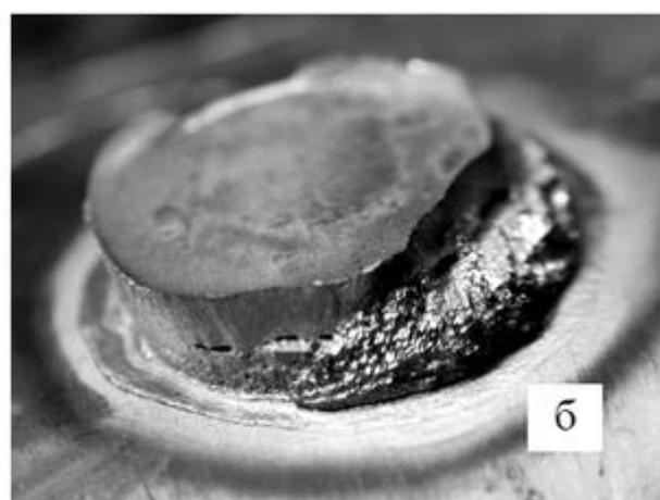
Рисунок 27 – Макрорельеф излома плазменной точки после испытаний на разрыв: а) - с разрушением по основному металлу; б) - с разрушением по основному металлу и по литой зоне точки, х8.
