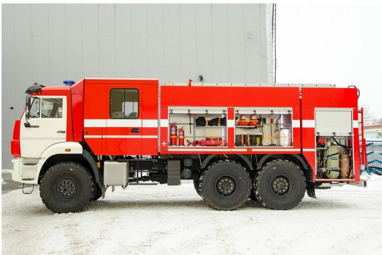
Рисунок 2 – Изображение АЦ 6,0-70 (43118) на базе «Камаз»
