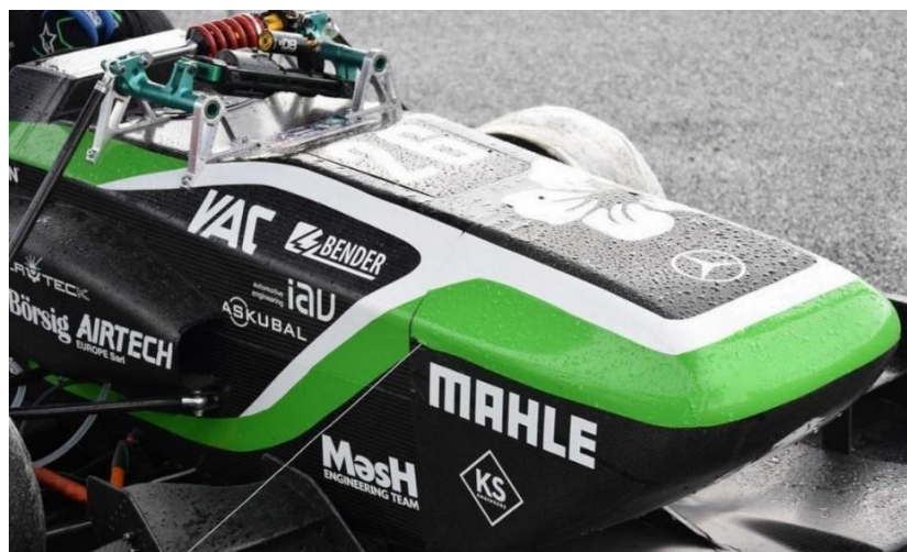
Рисунок 7 – Механизм, распределяющий включение амортизаторов при разных маневрах.
