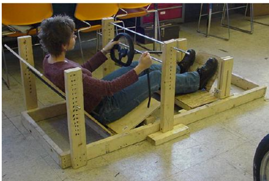
Рисунок 22 – стенд для проверки эргономики гоночного болида
