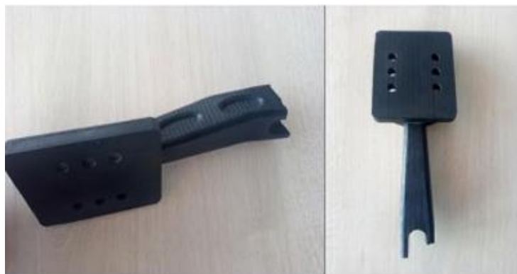
Рисунок 27 – Сломанная педаль сцепления из АБС пластика
