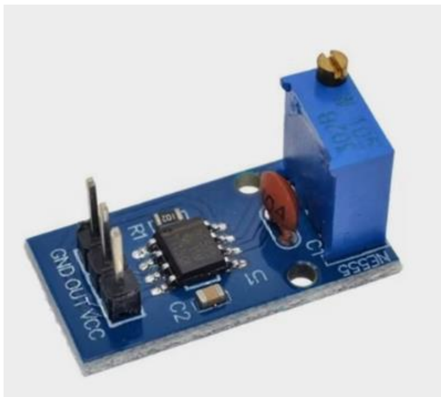
Рисунок 13 – Готовый генератор импульсов на базе NE555
