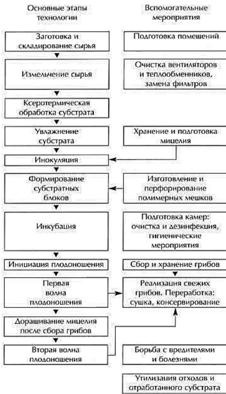
Рисунок 1 – Технологическая схема выращивания грибов
