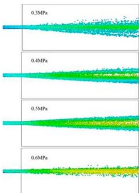
Рисунок 13 – Облачное изображение скорости частиц двухфазного потока при различных давлениях
