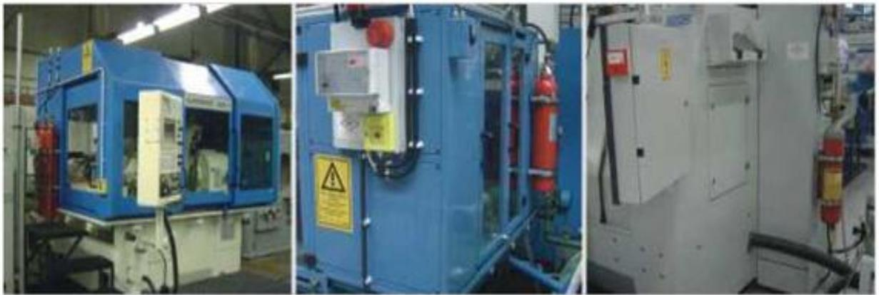
Рисунок 8 – Пример обеспечения пожаротушения станков [8]
