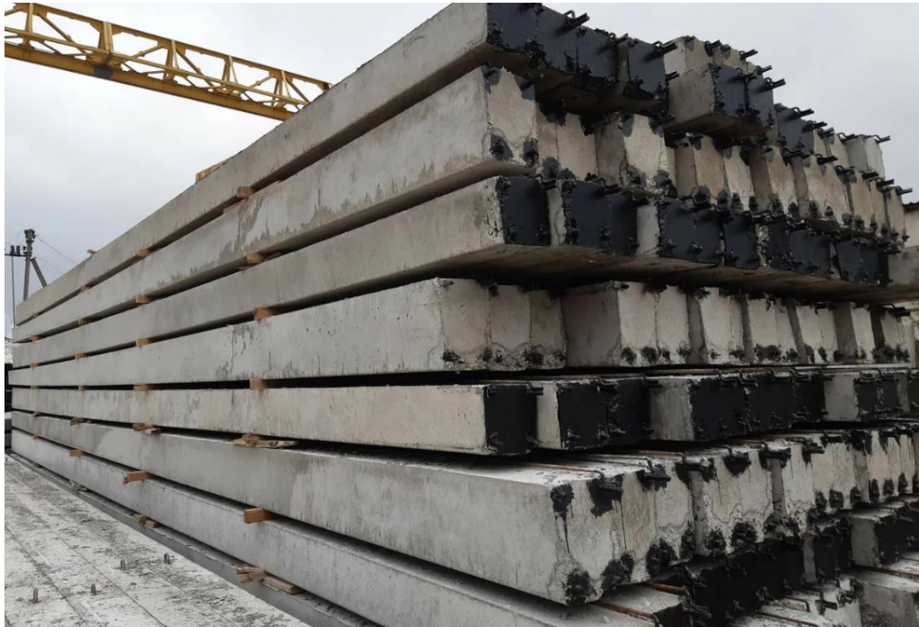
Рисунок 4 – Внешний вид опор СВ-95
