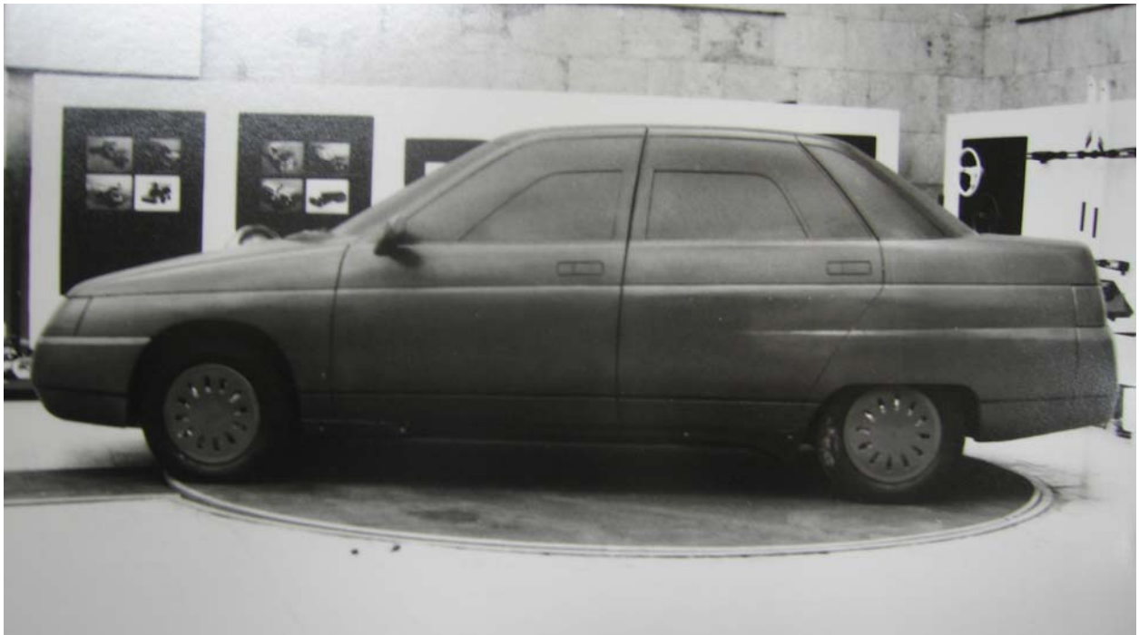
Рис. 25. Окончательная (после проектирования и конструирования) форма-эталон модели ВАЗ-2110 из пластика и дерева для итоговой оценки аэродинамических качеств. Начало 1990-х годов
