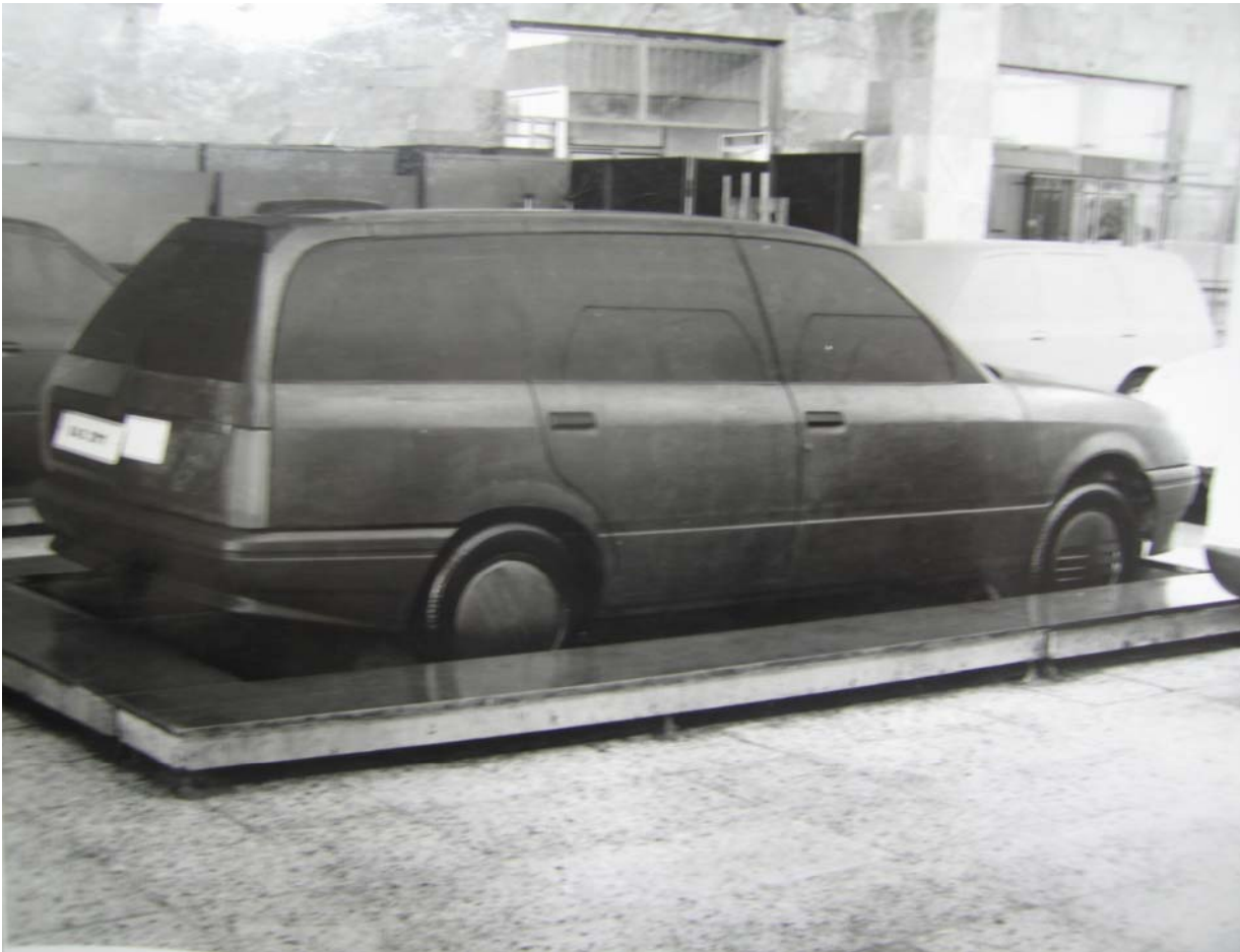
Рис. 23. Рабочий макет модели ВАЗ-2111 (первая версия) в М 1:1 с поверхностью из специального (скульптурного) пластилина. 1985 г. Автор С.А. Зайцев
