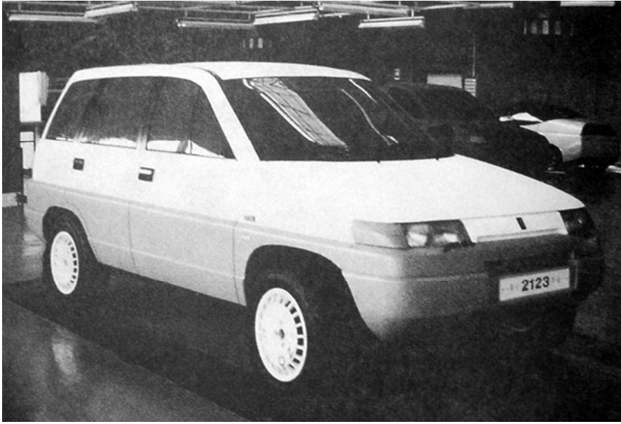
Рис. 22. Демонстрационный макет формы модели ВАЗ-2123 («Шеви-Нива» первой версии) в М 1:1 из полистирола с отделкой поверхности и деталей
