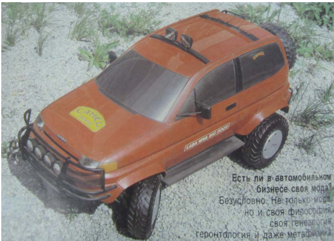
Рис. 21. Поисково-демонстрационный макет возможной модификации модели ВАЗ-2123 («Шеви-Нива» первой версии) – «Биг Фут» в М 1:5 из стеклопластика. Начало 1990-х годов. Автор А. Беляков
