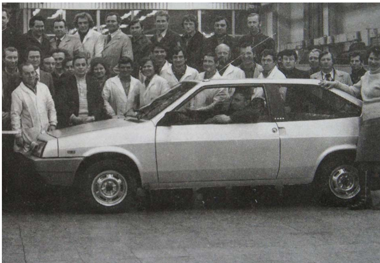
Рис. 24. Первый ходовой опытный образец модели ВАЗ-2108. Декабрь 1979 г. Форма почти полностью соответствует демонстрационному макету дизайн-формы модели
