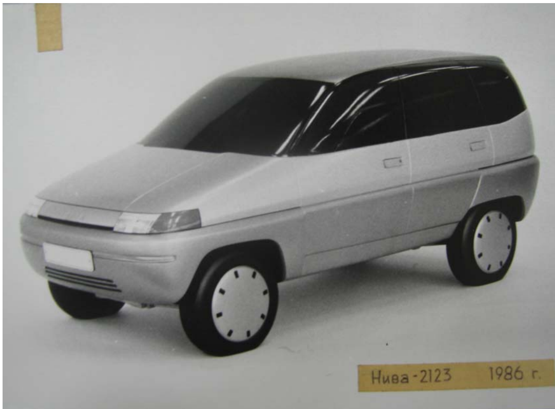
Рис. 20. Поисково-демонстрационный макет автомобиля ВАЗ-2123 («Шеви-Нива первой версии) в М 1:5 из стеклопластика (прообраз модели «Хонда HR-4, 5»). Конец 1980-х годов. Автор А. Беляков
