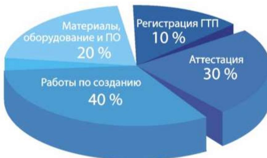
Рисунок 13 – Примерная структура затрат на внедрение АСКУЭ
