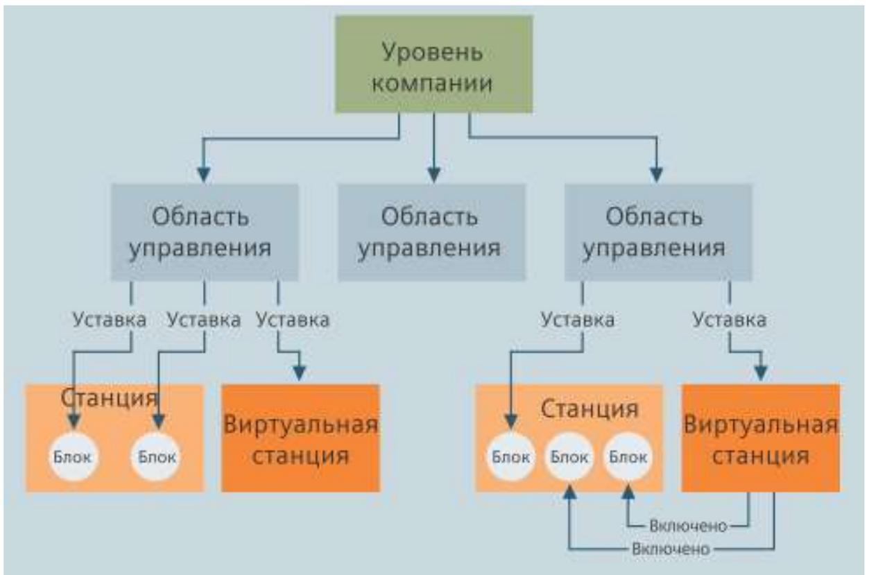
Рисунок 9 – Концепция иерархического управления АСКУЭ марки Spectrum Power 5
