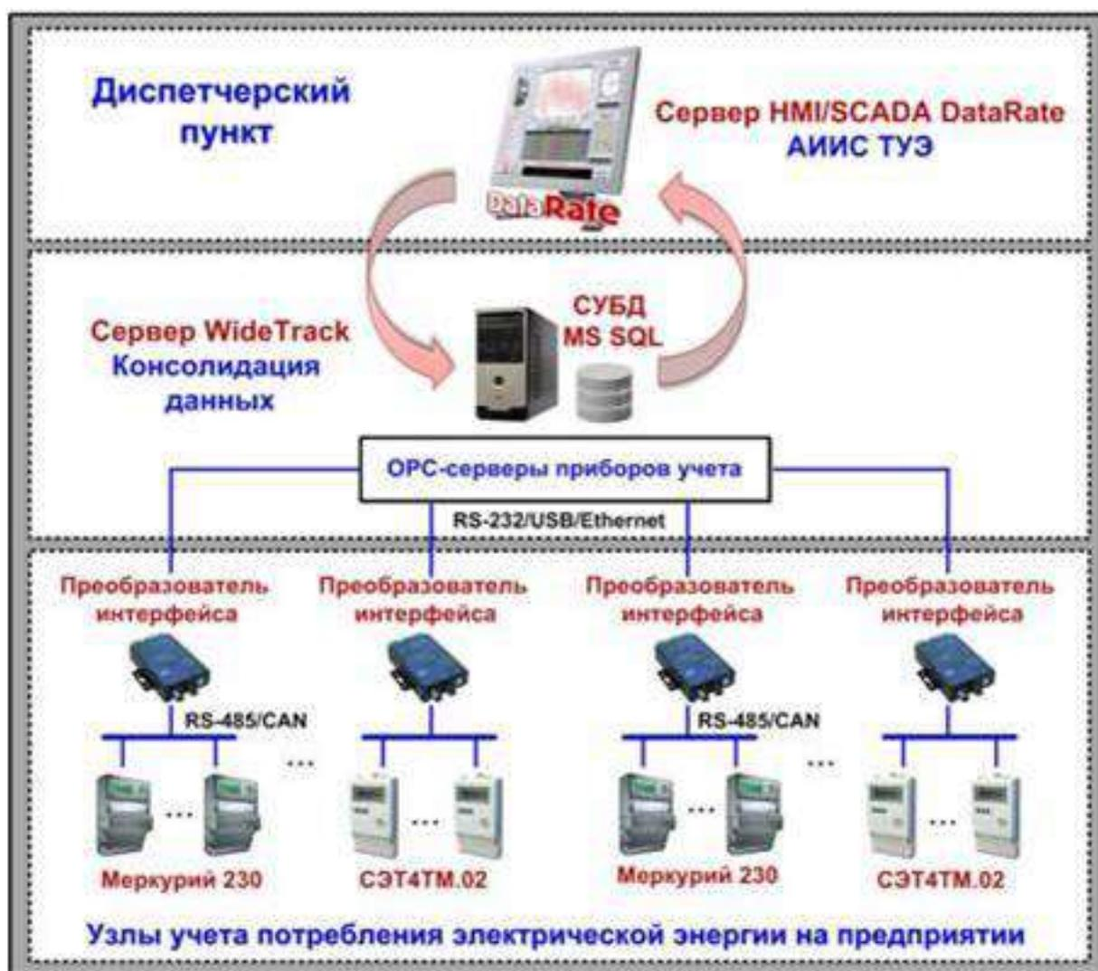
Рисунок 4 – Состав архитектуры системы трехуровневой иерархической схемы с сервером консолидации технологических данных
