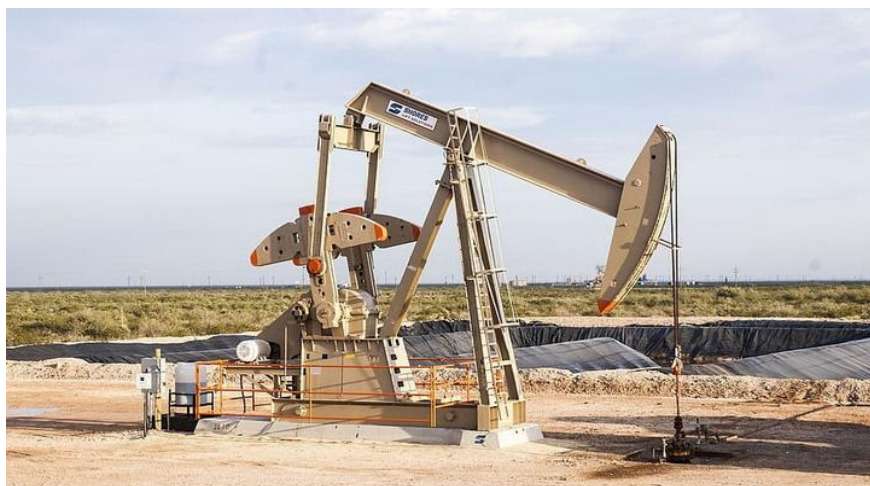
Рисунок 7 – Процесс добычи нефти при помощи установки штангового глубинного насоса (УШГН)
