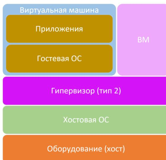
Рисунок 2 – Схема гипервизора второго типа
