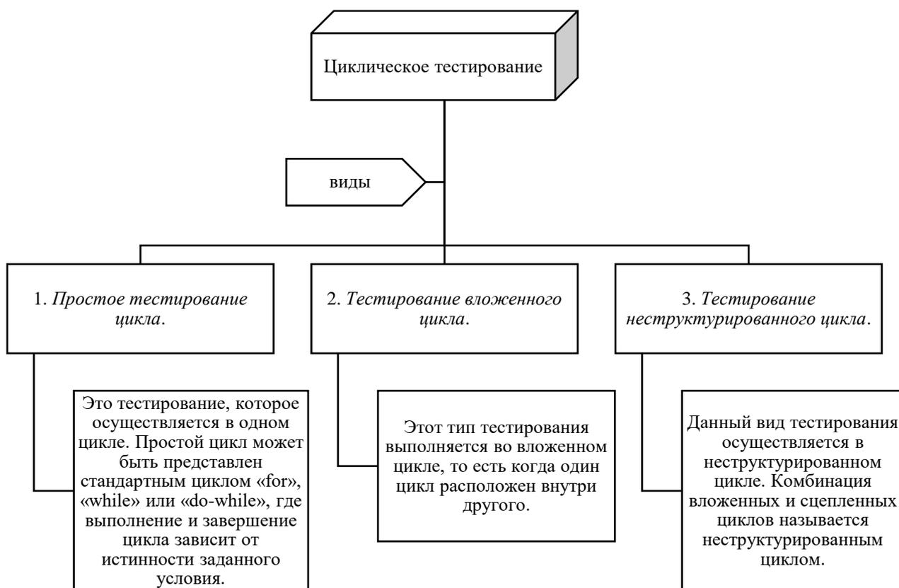
Рисунок 24 - Виды циклического тестирования
