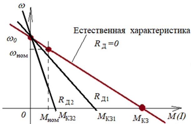
Рис. 2. Механические характеристики ДПТ с НВ
