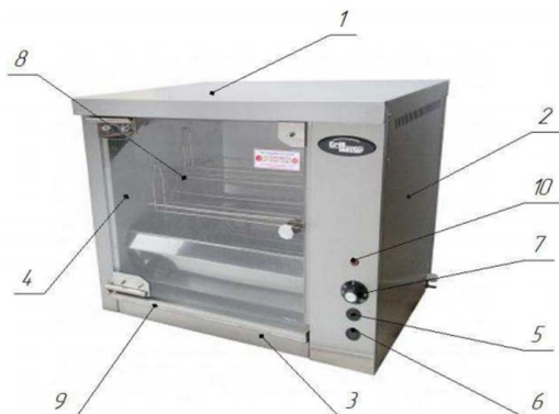
Рис. 17. Гриль карусельный электрический малый ФЗЛКМЭ: 1 – крыша; 2 – корпус гриля; 3 – основание; 4 – жаростойкое стекло; 5 – кнопка «вкл/выкл» освещения в камере; 6 – кнопка «вкл/выкл» вращения вертелов; 7 – ручка «вкл/выкл» нагревательных элементов; 8 – барабан с вертелами; 9 – поддон для сбора жира; 10 – сигнальный индикатор
