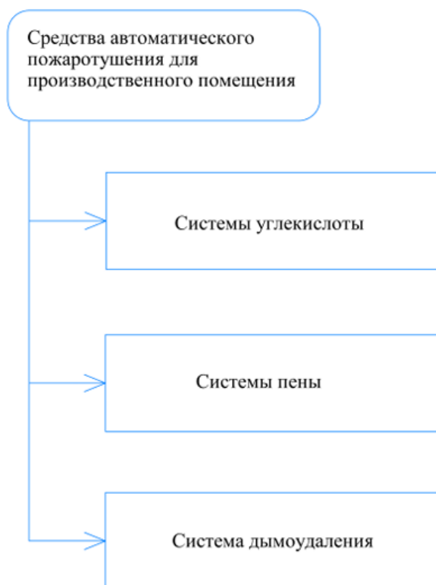
Рисунок 7 – Средства автоматического пожаротушения для производственного помещения
