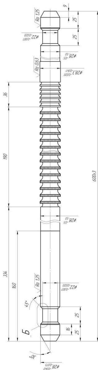
Рисунок 4 – Общий вид протяжки
