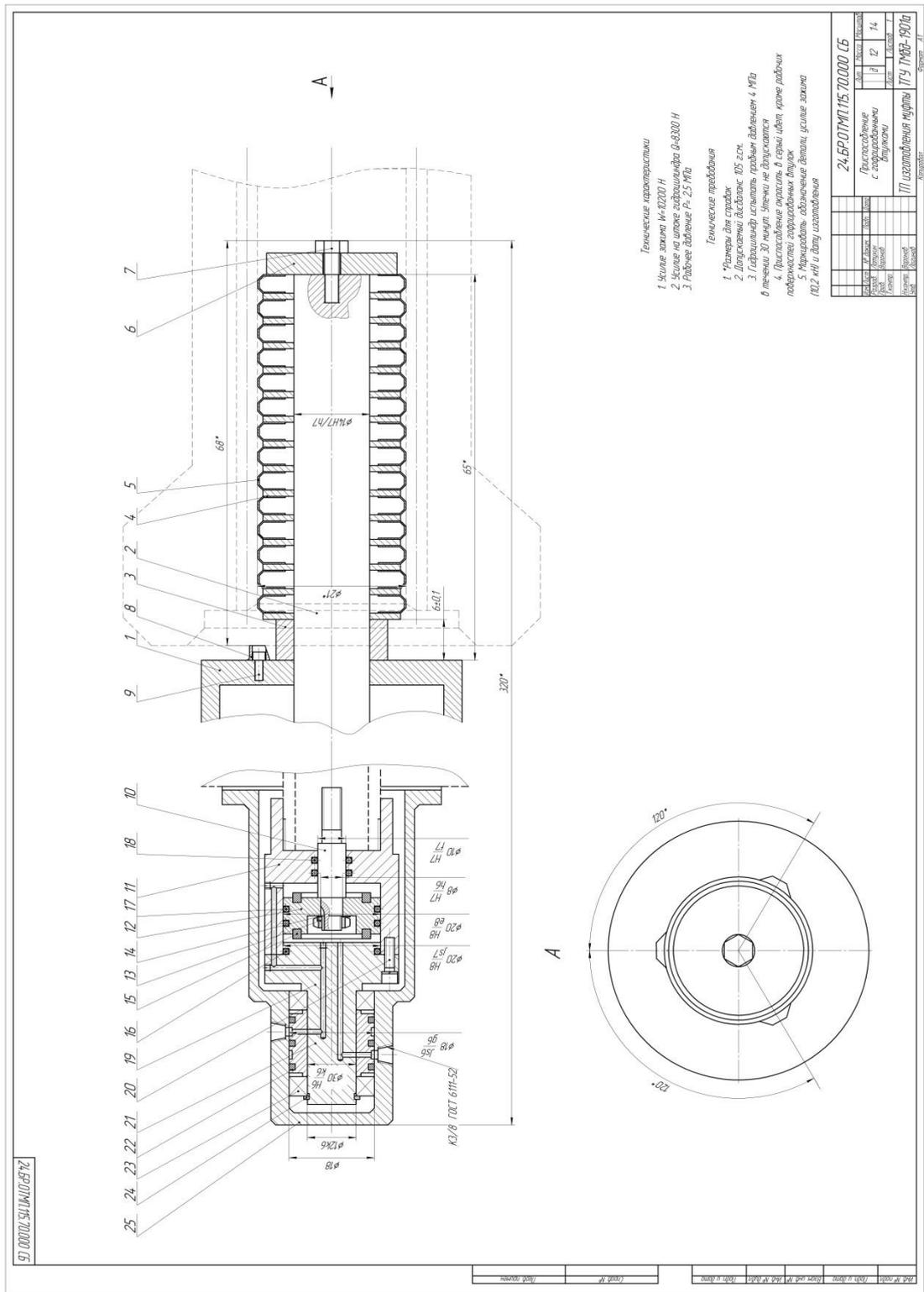
Рисунок 3 – Оправка с гофрированными втулками
