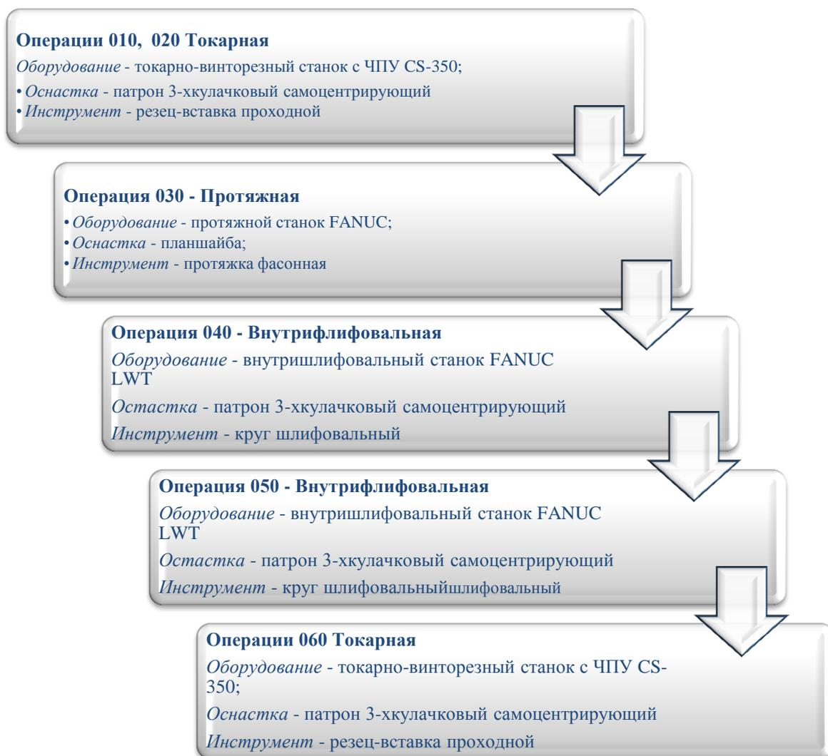
Рисунок 5 – Общее представление технологии изготовления детали
