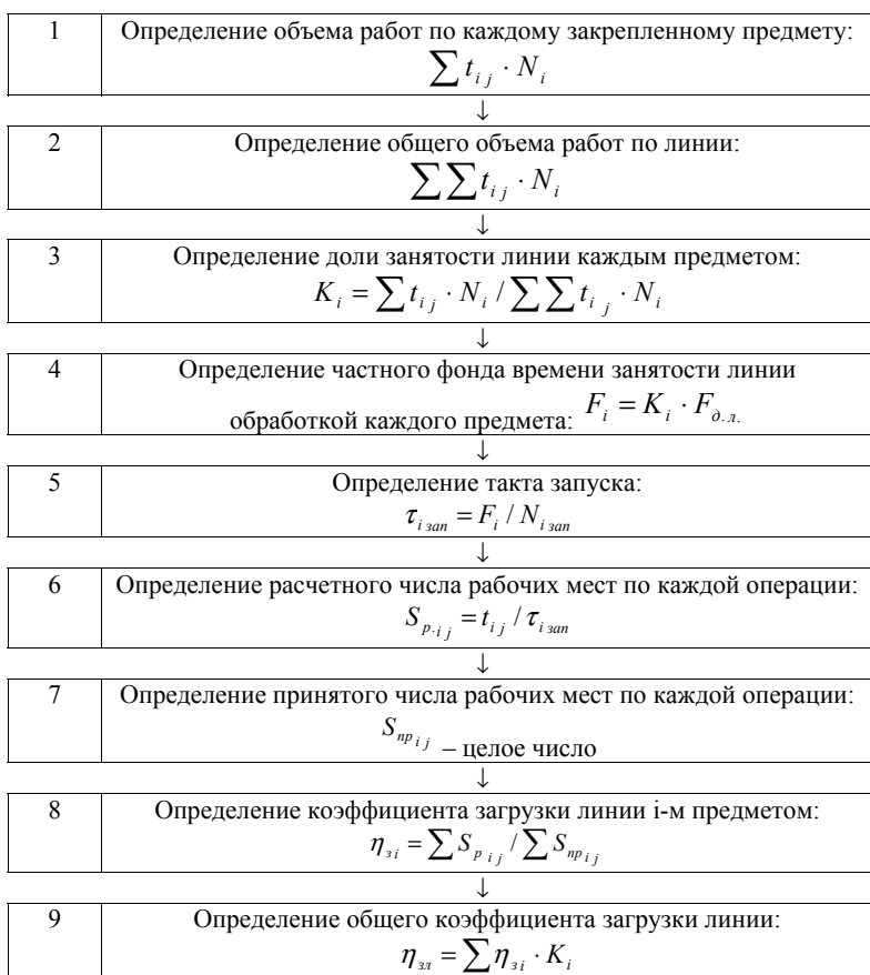
Рис. 53. Алгоритм расчета параметров переменной многопредметной поточной линии
