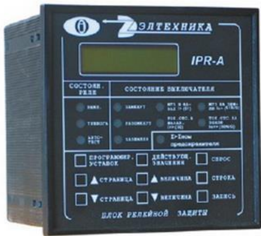
Рисунок 6 – «Микропроцессорный блок РЗиА марки IPR-A (производитель – ЗАО «Элтехника»)» [9]
