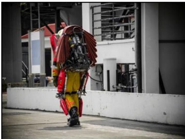
Рисунок 2 – Противопожарный экзоскелет Auberon Pneumatic Exoskeleton
