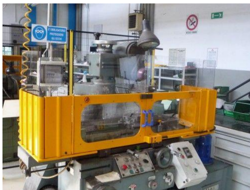
Рисунок 9 – Фрезерный станок со звукоизолирующим кожухом из оргстекла
