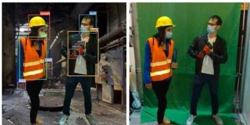
Рисунок 6 – Настройка системы распознавания СИЗ
