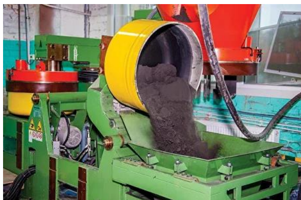
Рисунок 2 - Приготовление абразивной смеси.
