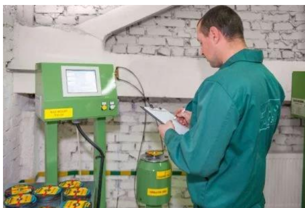
Рисунок 6 - Замер веса изделия и правильности формы
