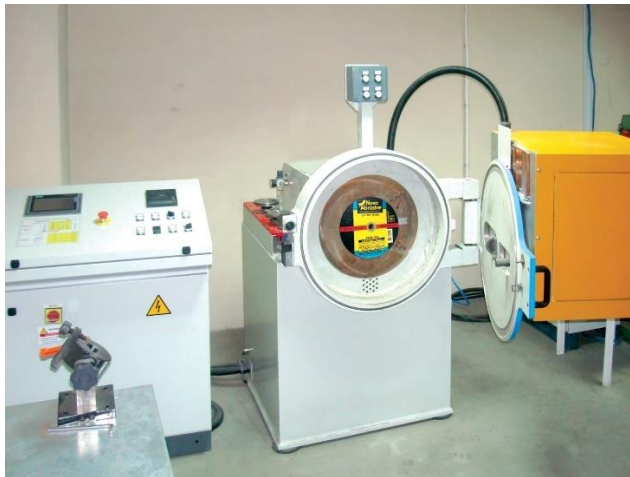
Рисунок 5 - Испытание на боковую нагрузку
