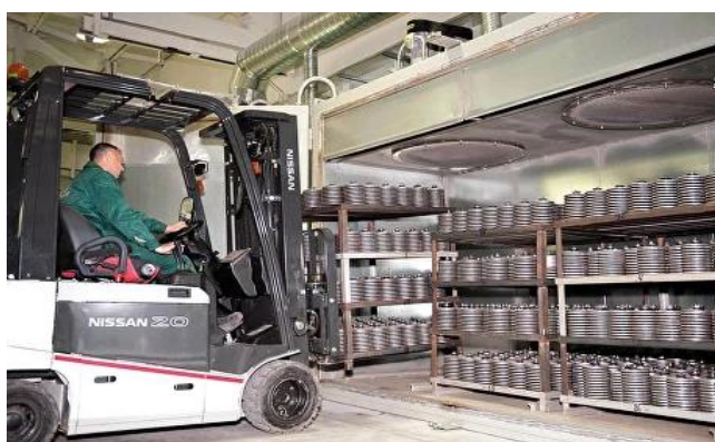
Рисунок 8 - Закладка в сушильную печь
