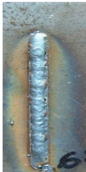
Рисунок 36 – Образцы при сварке ВСП-160(а), ВСПИ-160(б), Picomig 180 (в)
