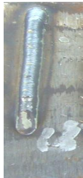
Рисунок 36 – Образцы при сварке ВСП-160(а), ВСПИ-160(б), Picomig 180 (в)
