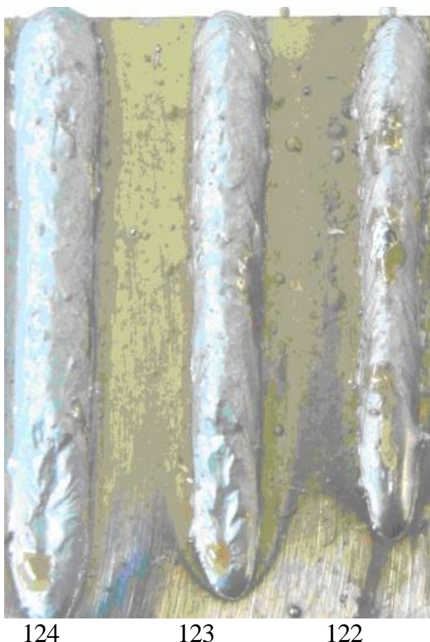
Рисунок 24 – Внешний вид образцов 122-124 при \partial U/\partial I = 0,04В/А , di/dt = 60кА/с
