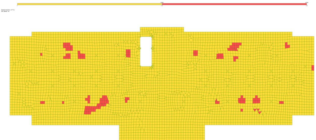
Рисунок 7 – Арматура в нижней зоне по оси Х
