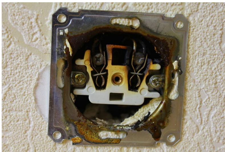
Рисунок 26– Окисления провода розетки однофазного инвертора
