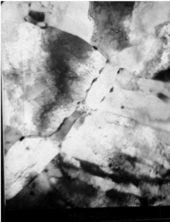
Рис. 5.16 – Микроструктура отводов из стали 05XГБ. Закалка 920 + отп. 600°C (Электронная микроскопия на просвет)
