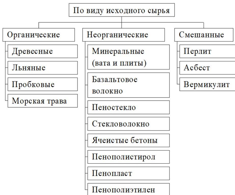
Рисунок 21 – Классификация теплоизоляционных материалов по виду исходного сырья
