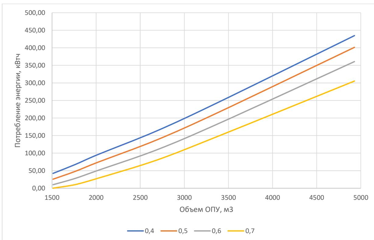
Рисунок 61 – Потребление электроэнергии резервным источником тепловой энергии для СН типовых ОПУ высотой 3,5 м в зависимости от коэффициента загрузки для системы без теплового аккумулятора
