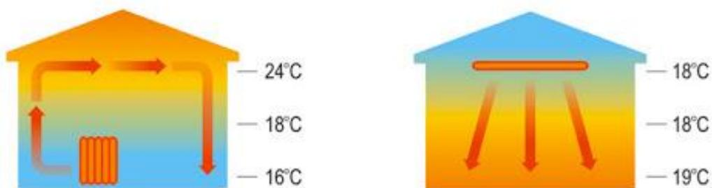
Рисунок 11 – Схема распределения тепла при конвективном отоплении (слева) и схема распределения тепла при инфракрасном отоплении (справа)
