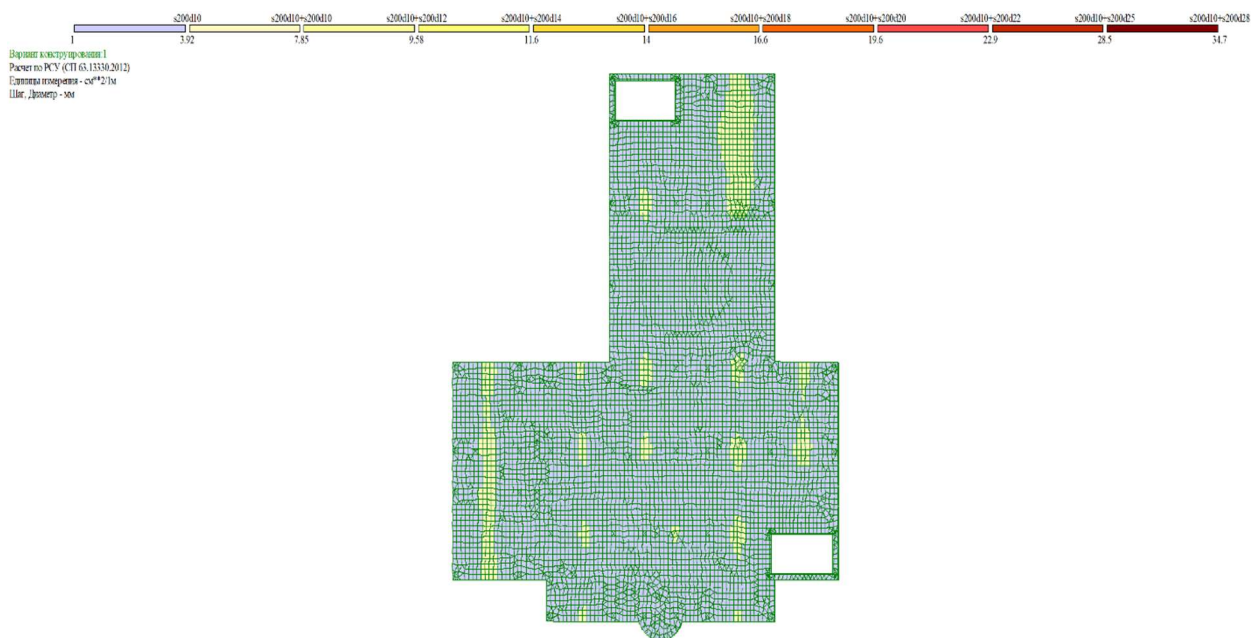
Рисунок 6 – Нижнее армирование плиты фундамента по оси X
