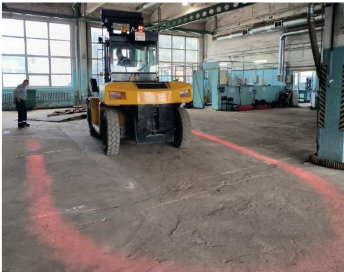
Рисунок 13 - Световой контур опасной зоны
