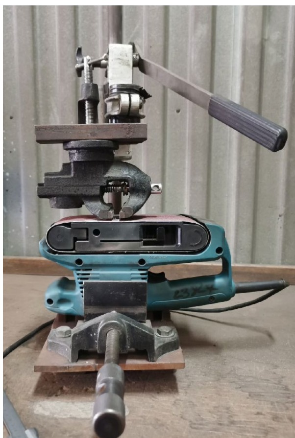
Рисунок 19 – Установка для испытания на износостойкость наплавленных образцов на износостойкость УХ-11 [14]
