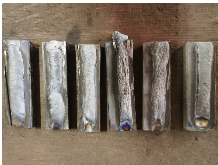
Рисунок 21 – Образцы наплавленных валиков аргодуговым способом с применением двух присадочных проволок
