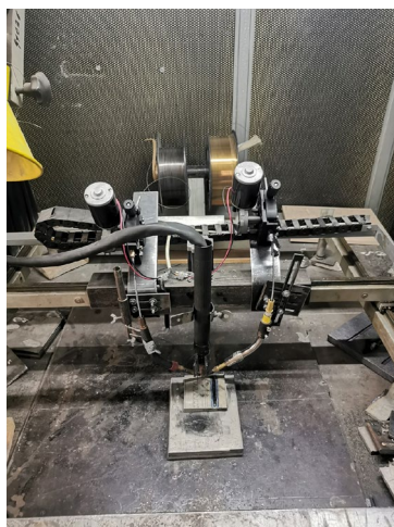
Рисунок 12 – Установка для автоматической аргодуговой наплавки неплавящимся электродом с подачей двух присадочных проволок УК-2
