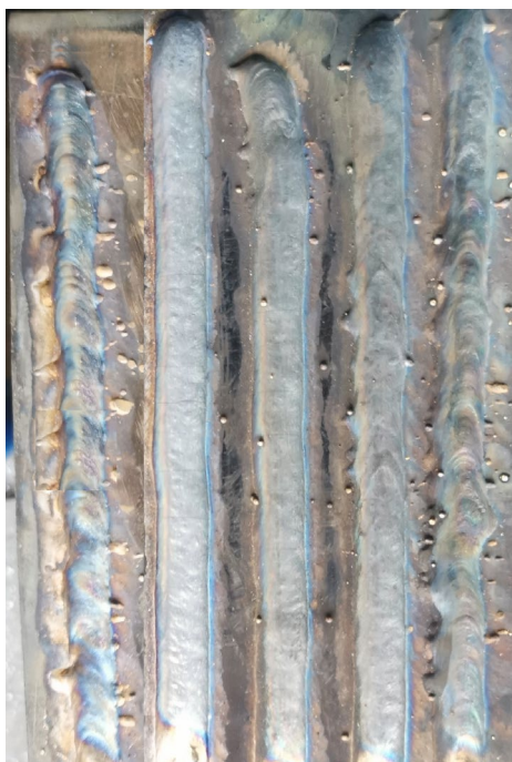
Рисунок 68 - Образцы наплавленных валиков дуговым способом, плавящимся электродом с применением электродной проволоки марки CuAl8
