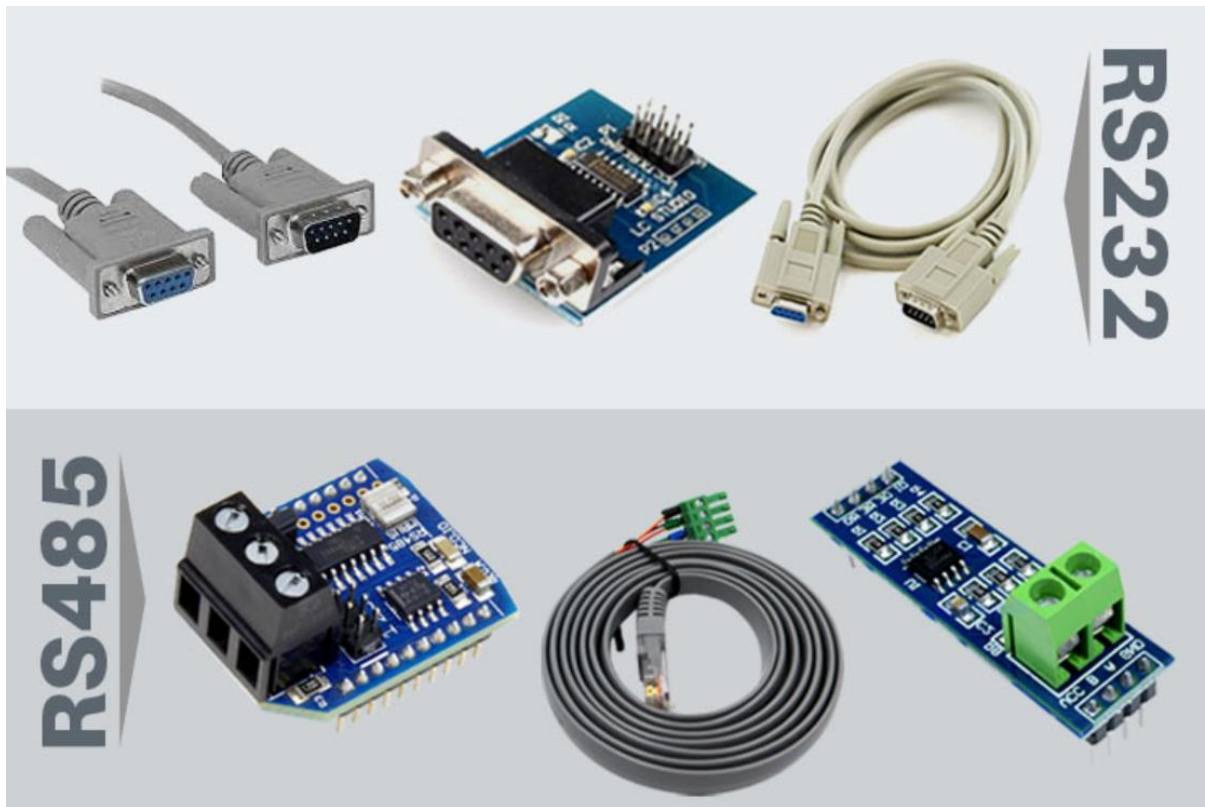
Рисунок 22 – интерфейсы RS232 и RS485
