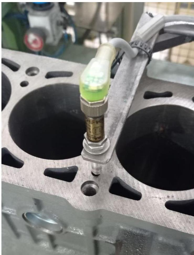
Рисунок 93 – Индуктивный датчик контроля
