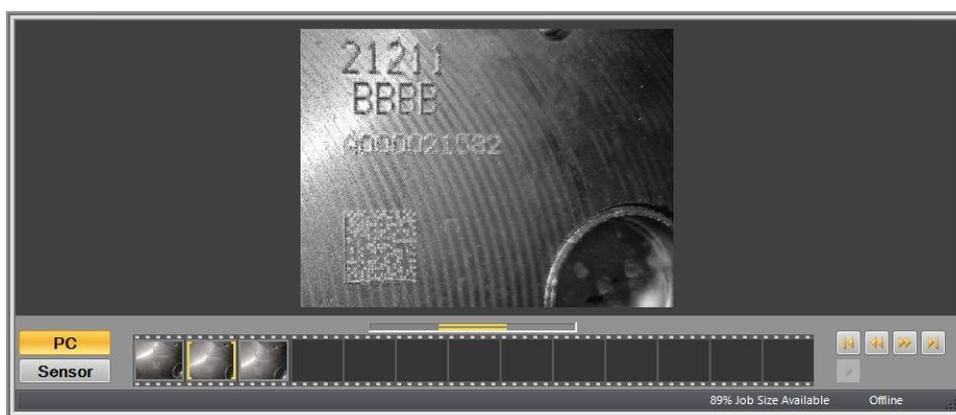
Рисунок 64 – Подготовленная буквенно-цифровая маркировка с 2D КОДОМ
