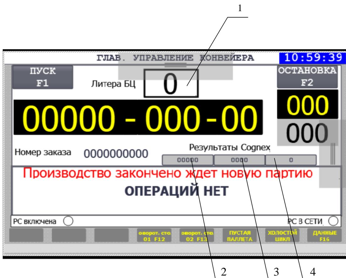
1 – значение литеры блока цилиндров, полученное из задания; 2 – классы коренных опор, считанный камерой из обозначения на блоке цилиндров; 3 – класс цилиндров, считанный камерой из обозначения на блоке цилиндров; 4 – литера блока цилиндров, считанная камерой из обозначения на блоке цилиндров.
