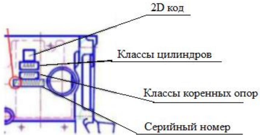
Рисунок 31 – Схематичное расположение маркировок на БЦ
