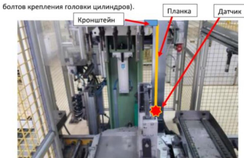
Рисунок 119 – Позиция установки датчика
