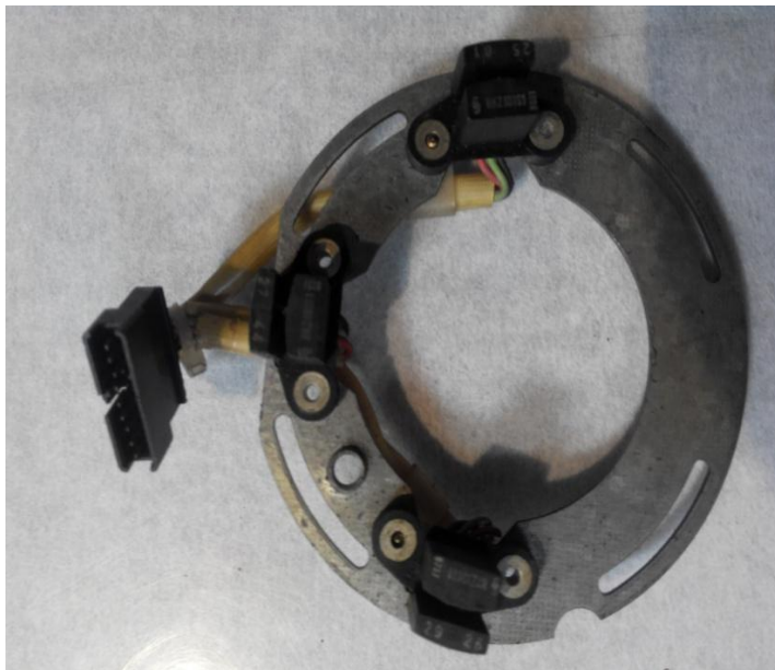
Рисунок 13 - Датчик положения ротора, который устанавливается на двигателях FT.
