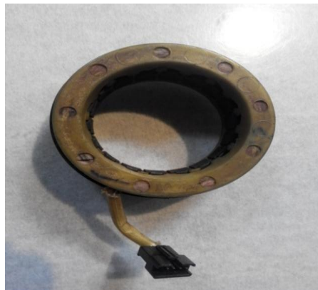
Рисунок 16 - Тахогенератор который устанавливается на двигателях 1FT5 фирмы Сименс.
