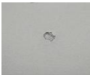
Рисунок 32 – Восстановленное изображение дефекта «отпечаток» с искажением «смаз»
