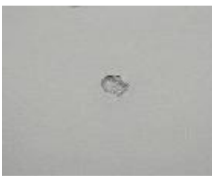
Рисунок 29 – Дефект «отпечаток» без искажения
