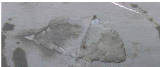
Рисунок 10 – Вкатанные металлические частицы
