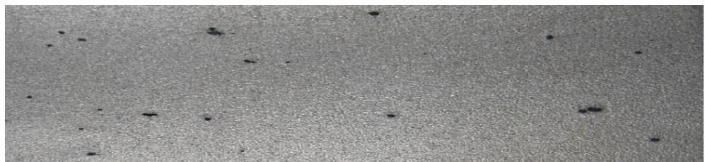
Рисунок 9 – Вкатанные инородные частицы
