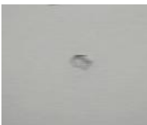
Рисунок 30 – Дефект с искажением «смаз»
