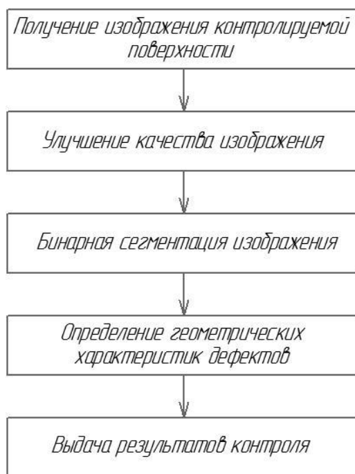
Рисунок 48 – Алгоритм цифровой обработки изображения
