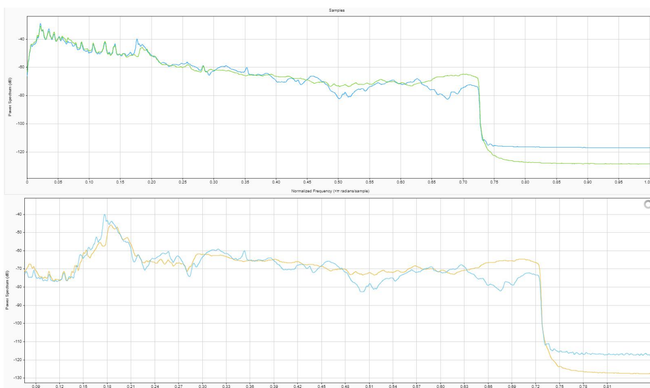
Рисунок 20 – Сравнение двух проходов до и после фильтрации
