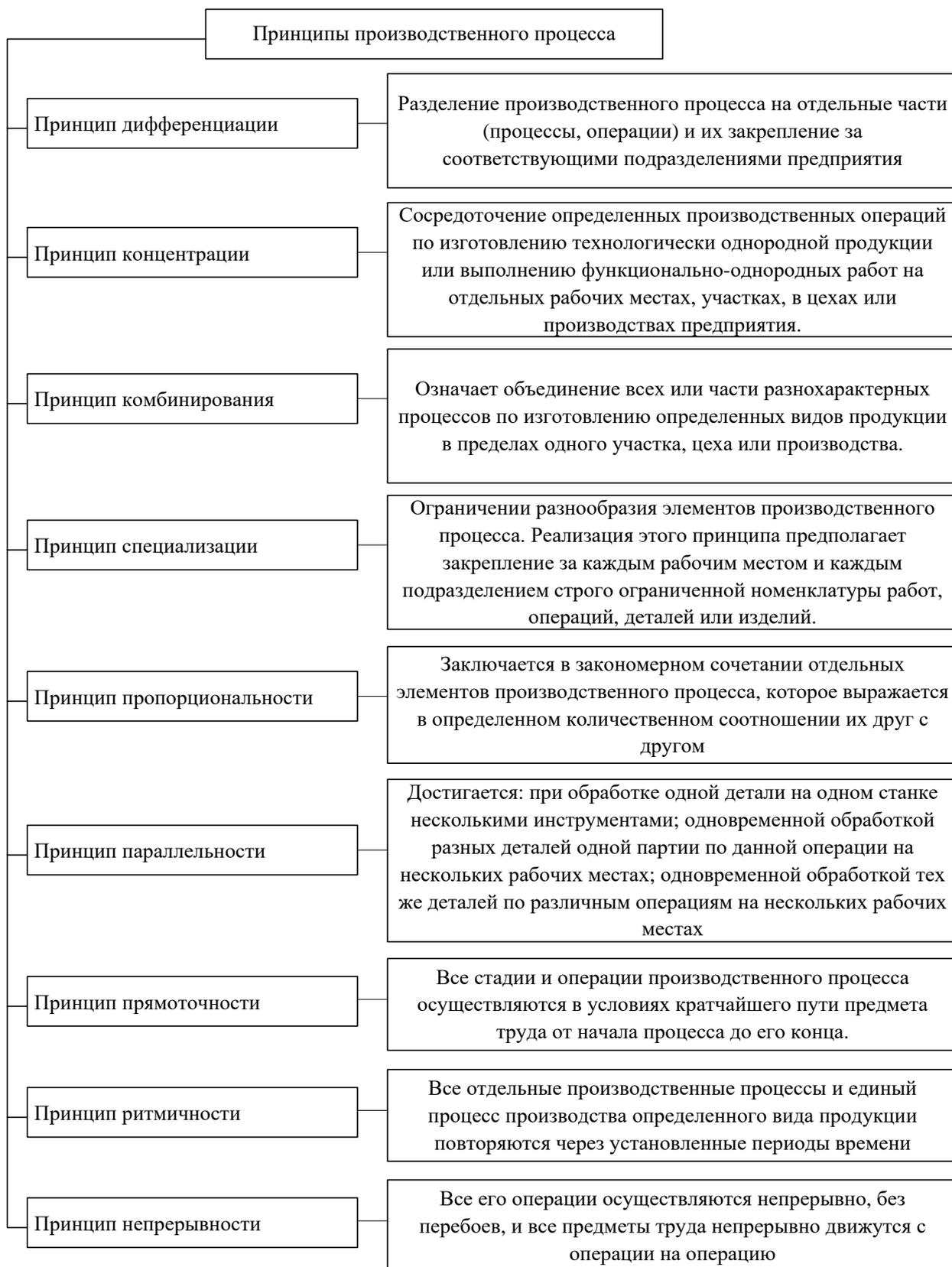
Рисунок 3 – Основные принципы производственных процессов
