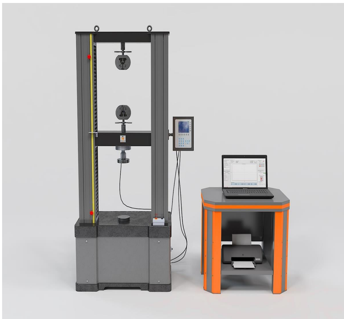
Рисунок 6 – Установка для проведения испытаний на растяжение
